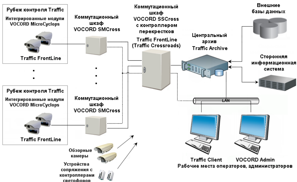
Рис. 3.8. Структурная схема территориально-распределенной системы фотофиксации нарушений ПДД «Вокорд-Трафик» на перекрестке
