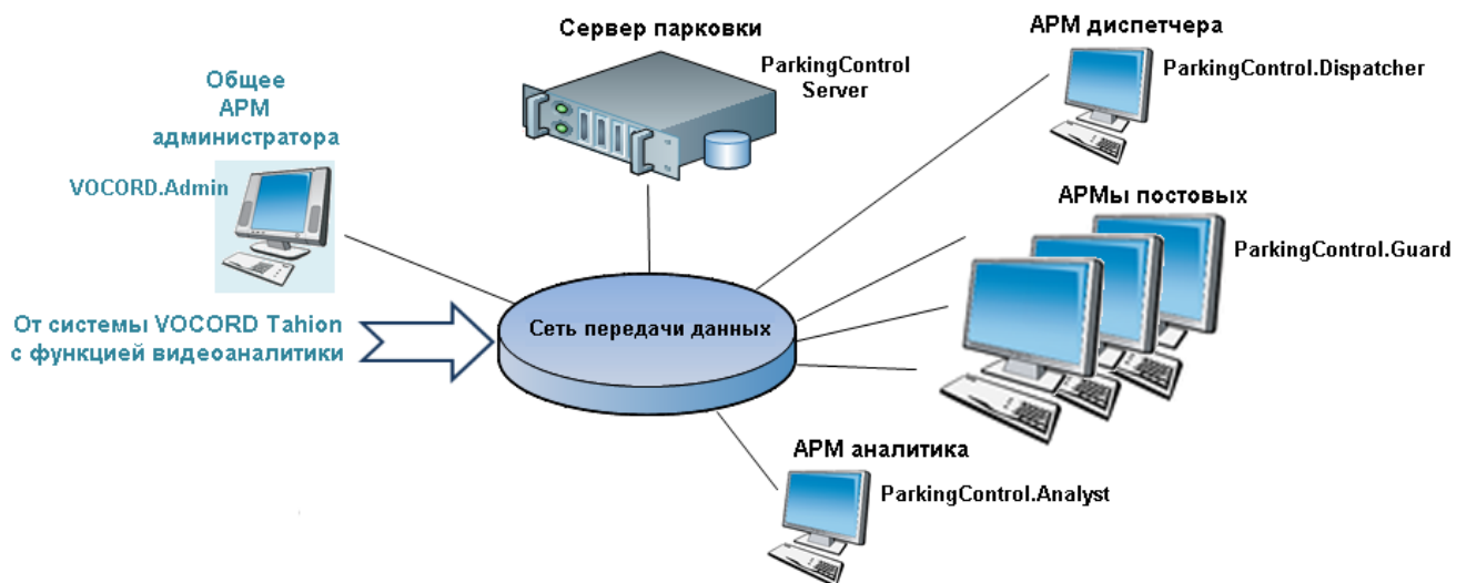
Рис. 2.1. Структурная схема системы VOCORD ParkingControl
