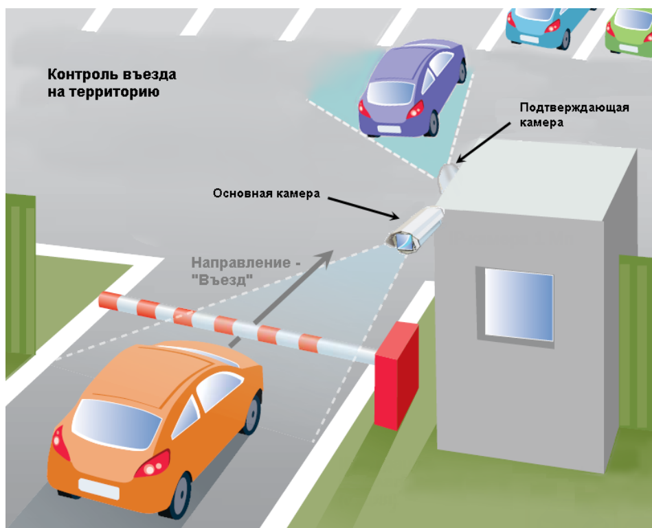
Рис. 2.3. Пример направленности основной и подтверждающей камер
