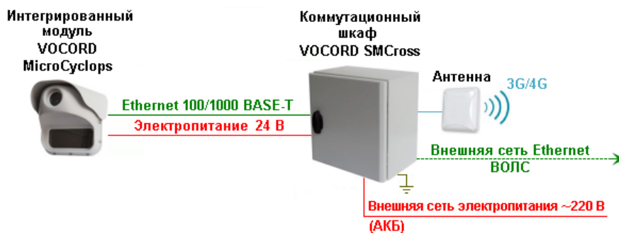
Рис. 5. Внешние подключения SMCross. Типовая схема 2
