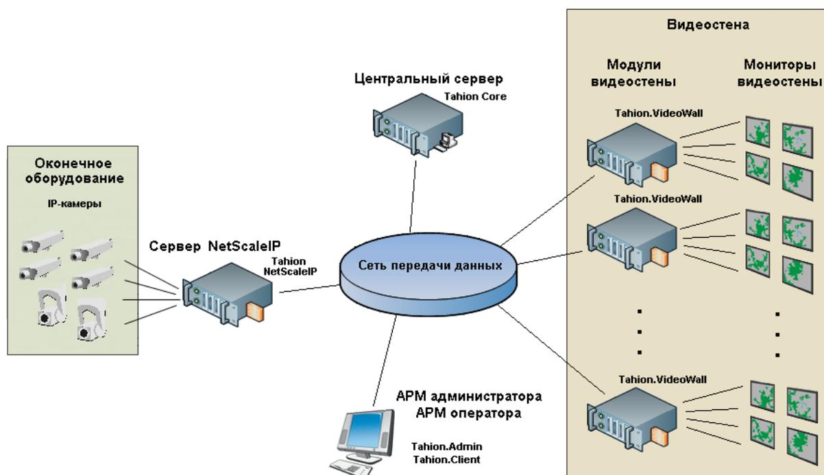
Управление потоками видеоданных для видеостены и сценариями ее работы осуществляется на центральном сервере, в состав ПО которого входит служба управления видеостеной. Поточное видео с камер через серверы NetScaleIP поступает на модули видеостены – компьютеры с установленным на них приложением **Tahion.VideoWall** и подключенными к ним мониторами видеостены. Приложение **Tahion.VideoWall** предназначено для просмотра потокового видео на мониторах видеостены.
