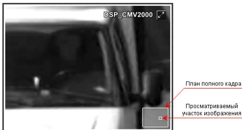
Просмотр сквозного канала и воспроизведение архивной записи в ячейке с увеличенным изображением производится таким же образом, как и без увеличения, с тем отличием, что в ячейке видна только часть кадра.
