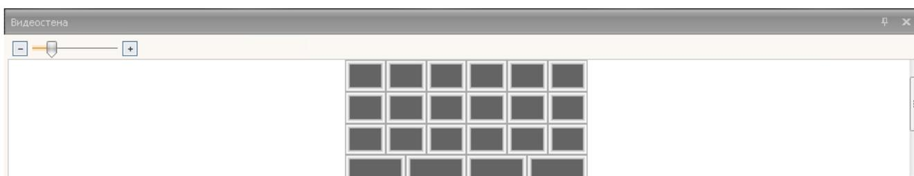
3. Добавьте камеры в ячейки раскладки. Одна камера может быть добавлена только в одну ячейку. При добавлении камеры ее название отображается на реальном мониторе видеостены в заданной ячейке. Если с камеры передается видео, то оно будет показано на реальном мониторе в заданной ячейке. Камера добавляется в раскладку одним из следующих способов.
